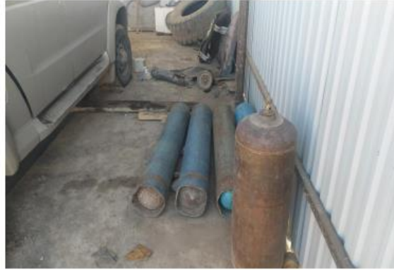
Фото 5: В ангаре для ремонта автомашины разбросаны кислородные баллоны, тем самым, в случае сварочного ремонта автомашины создает опасность взрыва/ Photo 5: Oxygen cylinders are scattered in the car repair work-shop, thus creating a risk of explosion in the event of a welding
